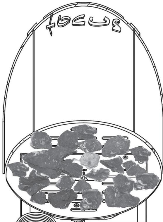
Disperse las bolsas de ascuas sobre los quemadores tal como se muestra, manteniendo el área del piloto despejada.
