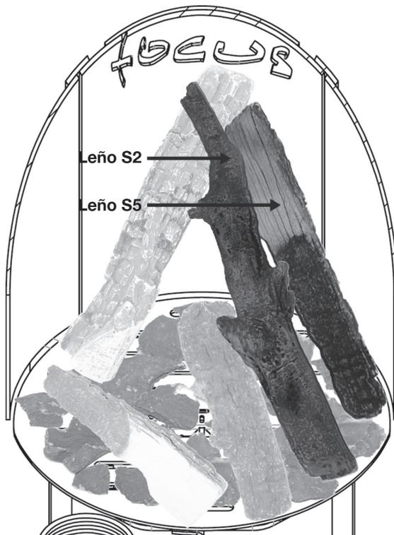
Coloque los leños S2 y S5 tal como se muestra en el diagrama. Disperse las hebras brillantes encima de los leños y las ascuas. Finalmente, compruebe el encendido del piloto y la iluminación cruzada para asegurarse de que ningún material afecte al funcionamiento del piloto.
